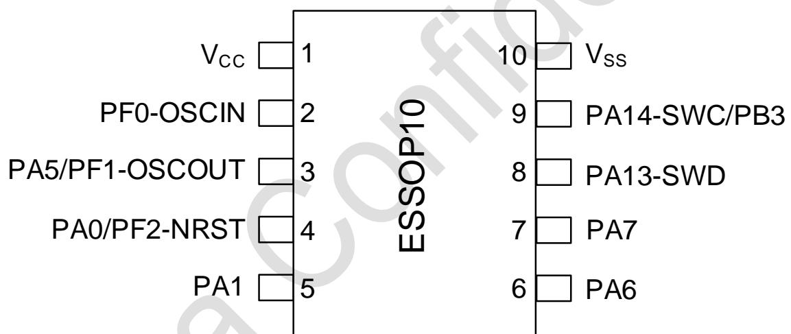
图 3-6 ESSOP10 Pinout1 PY32F002AA15Mx
