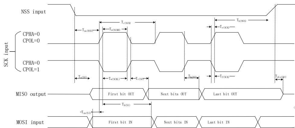
图 5-3 SPI 时序图 – 从机模式, CPHA = 0
