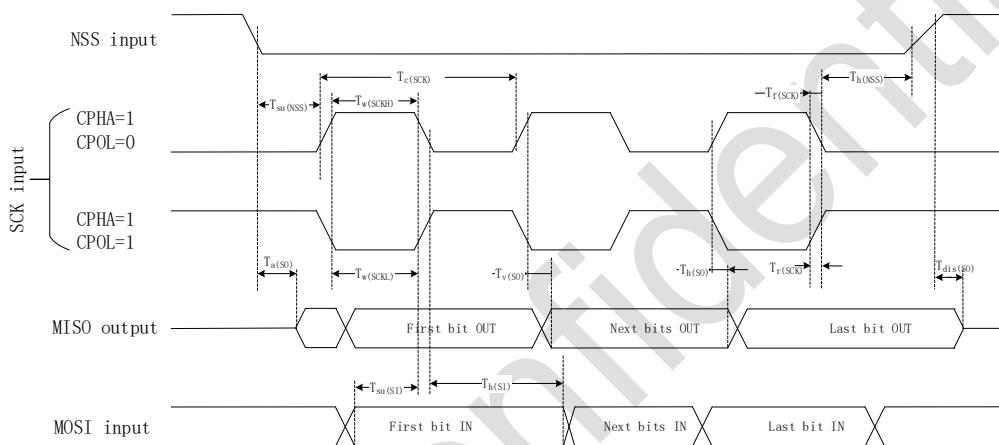
图 5-4 SPI 时序图 – 从机模式, CPHA = 1
