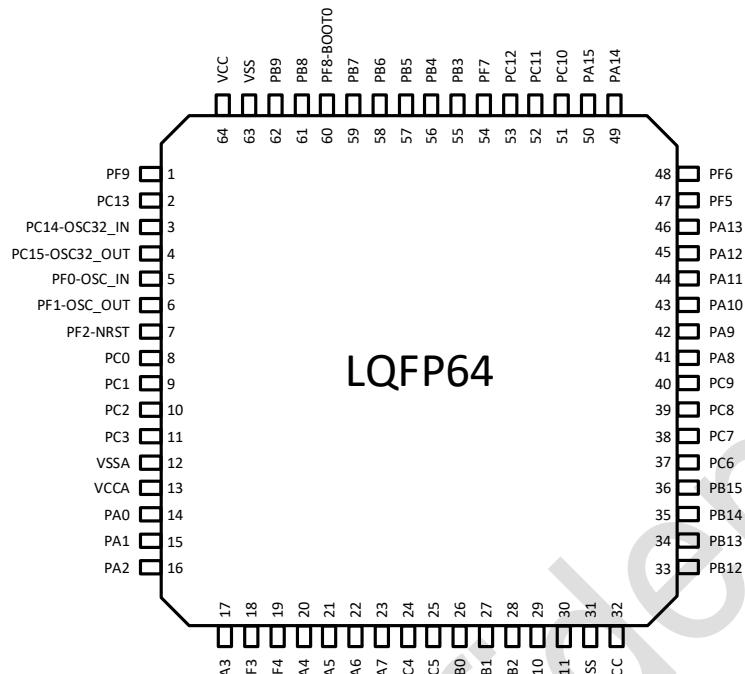
图 3-1 LQFP64 PY32F071R1xT6 Pinout1(Top view)
