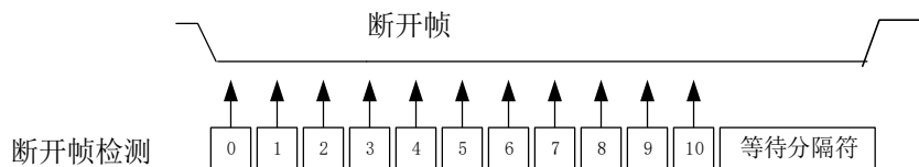
图 32-10 LIN 模式下的断开帧长度够的情况
